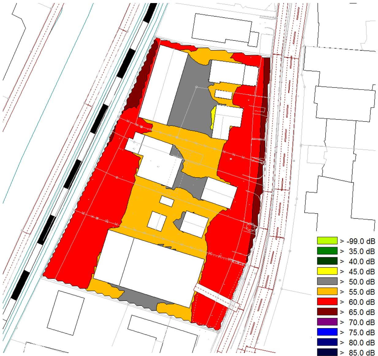
Abbildung 4: Verkehrslärm-Beurteilungspegel nachts in dB(A), Rasterhöhe 4 m
