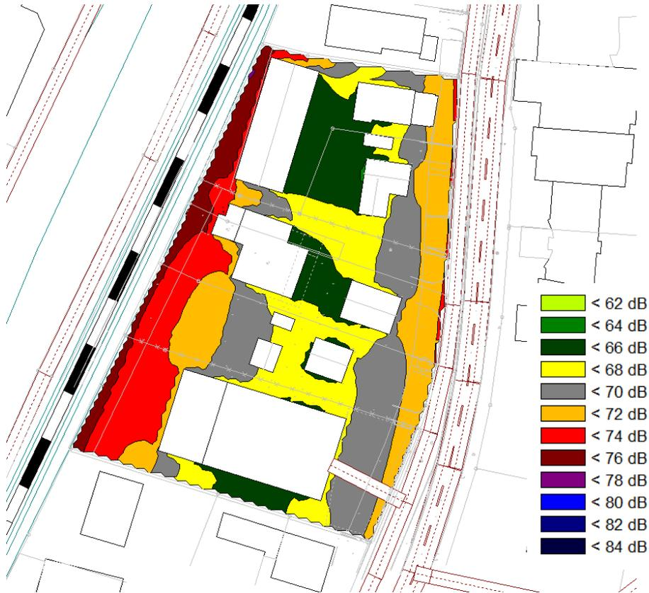
**Abbildung 6: Maßgeblicher Außenlärmpegel in dB(A) im Erdgeschoss**
