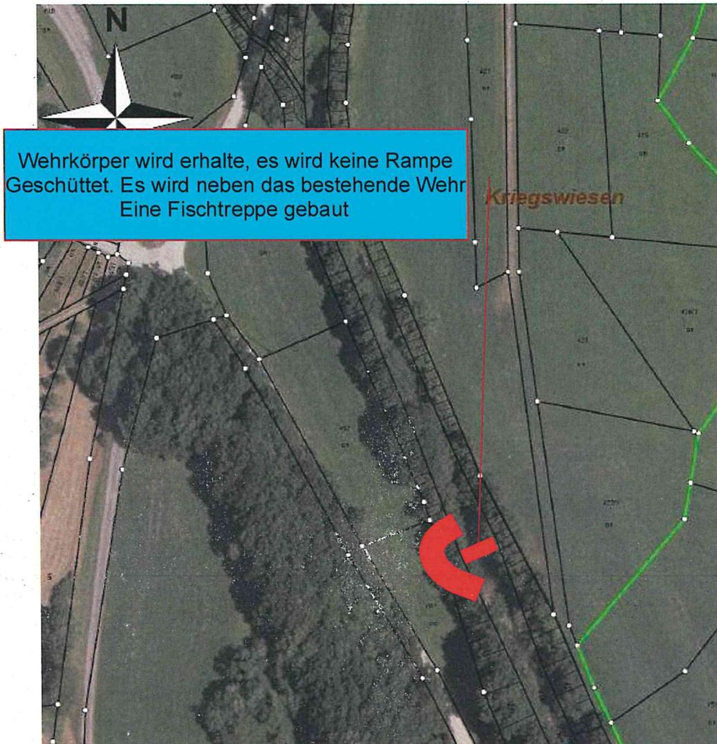
**Abb. 11:** Entwurfsskizze Variante III Erhalt des Wehrkörpers / keine Rampe / Bau einer Fischtreppe
