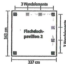
Hinweis: Diese Pavillons sowie die Pfosten der Wandelemente werden aus kesseldruckimprägniertem Massivholz, die Profilbretter der Seitenwände aus naturbelassenem Massivholz gefertigt.
