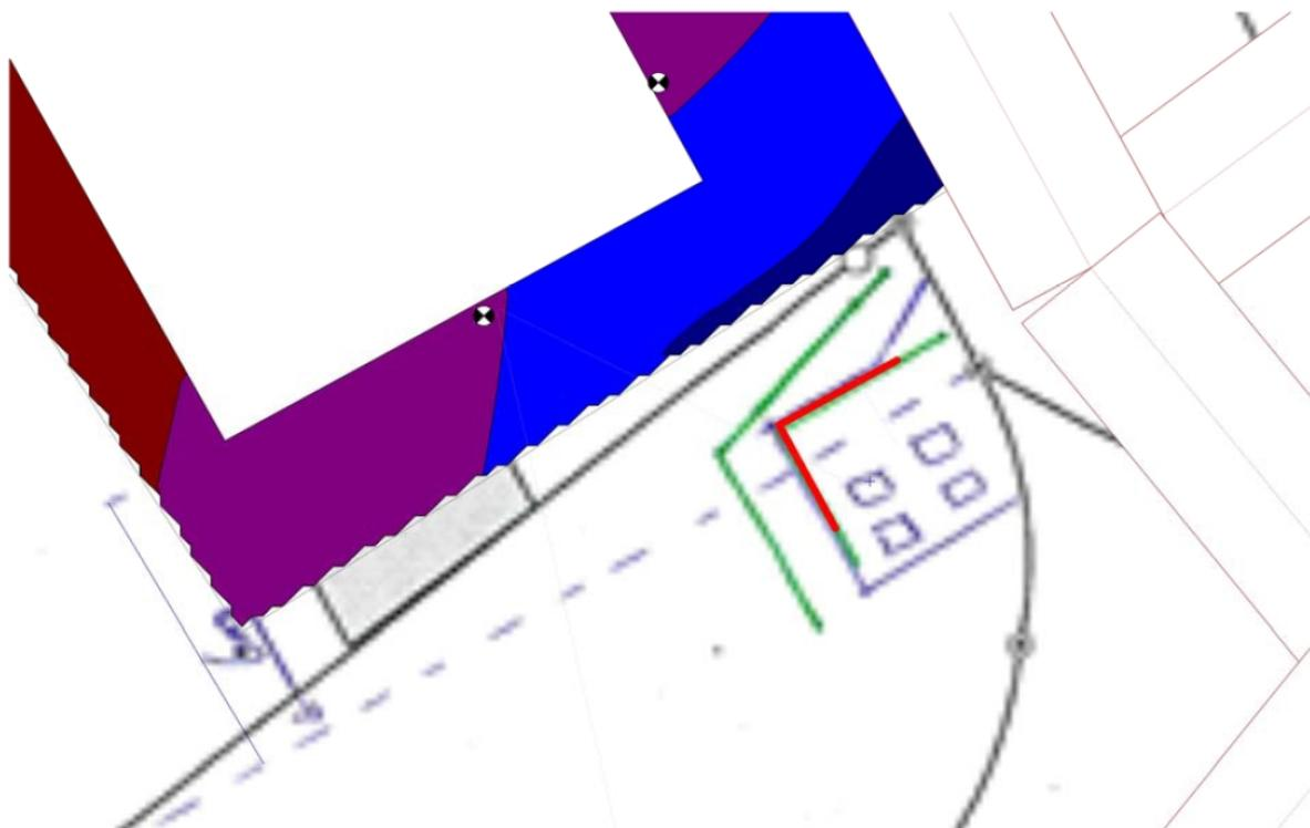
Die Lärmschutzwand kann aus einer Holzkonstruktion, evtl. schallabsorbierend, ausgeführt werden. Die Höhe soll mindestens 2,7 m, die Länge mind. 5 m insgesamt (um die Ecke) betragen.
