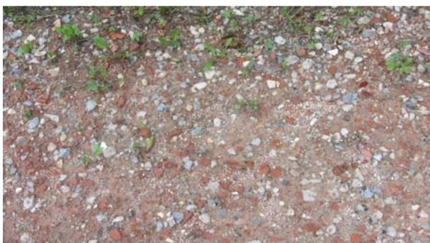
**Abb. 20:** Ziegelbestandteile im Belag der Lagerfläche (60.41)
